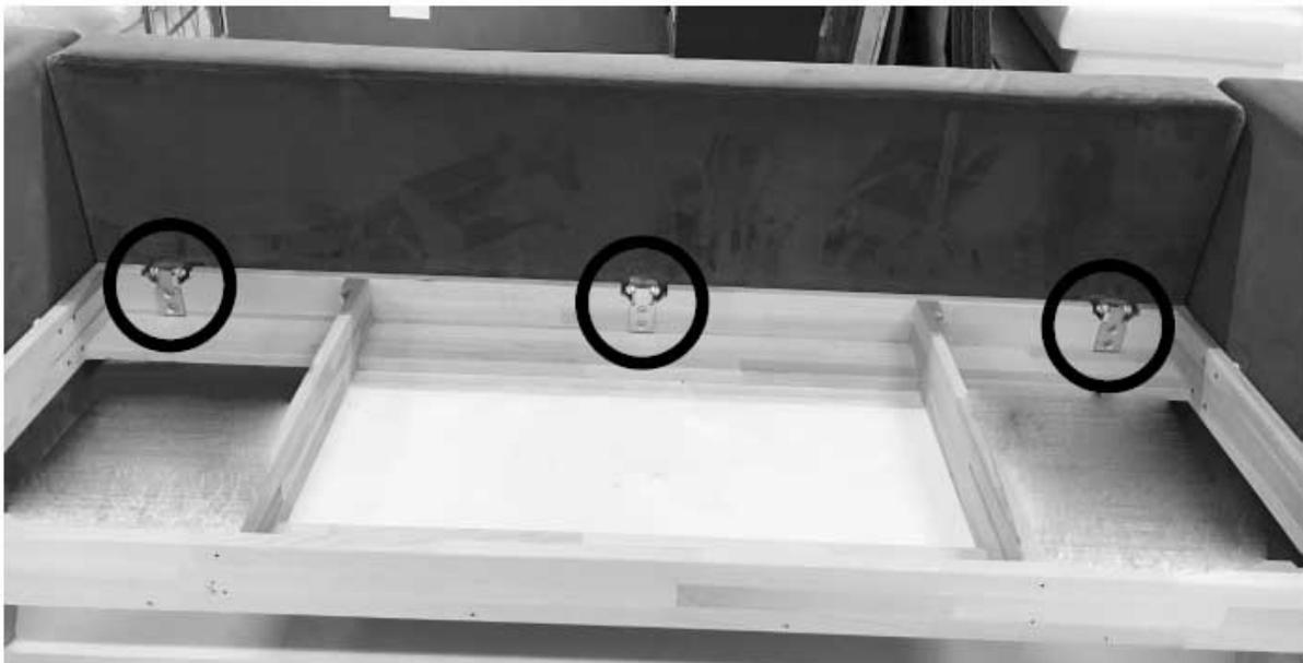
Verbinden Sie die Scharniere des Moduls mit der Liege und nutzen Sie hierfür die oben abgebildeten Schrauben.
